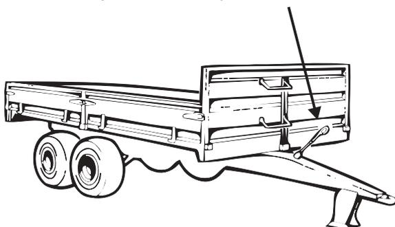
3. Kiinnitä askelmat ruuveilla etulaitaan, irtoskelma on tarkoitettu sisäpuolelle. Ulkopuolinen askelma asennetaan lavassa olevaan taskuun. Askemat asennetaan vastakkain vinosti alaspäin.
