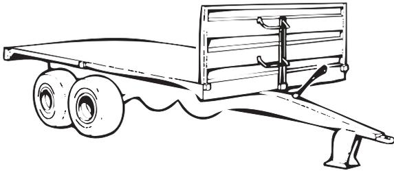
4. Asenna viljalaitojen kulma- ja keskikarikat sekä 40 cm korkea etuviljalaita. Seiso lavalla kun nostat laitaa paikoilleen. 41 cm korkeat perusviljalaidat, asennetaan vaunuun sivulta työntämällä laita saranoiden vastakapalleeseen. Älä sulje laitoja.
