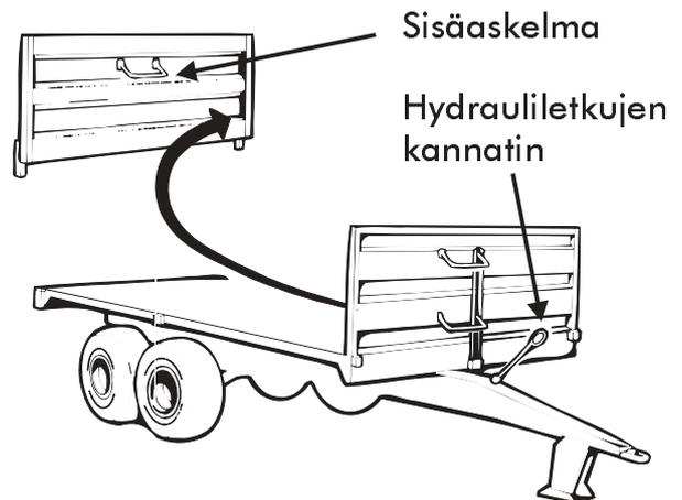
5. Ripusta takaviljalaita karikkojen päissä oleviin pidikkeisiin. Laita on 74,5 cm korkea ja sen alareunassa on kaksi holkkia. Nosta sivulisälaidat paikoilleen, laidat menevät karikoissa oleviin hahloihin pujoittamalla noin 30° kulmassa. Sulje lisälaidat.
