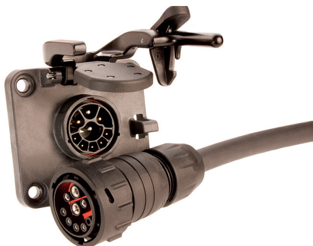
Kuva 73. kylvökoneen ISOBUS-kaapeli ja traktorissa oleva pistoke.
