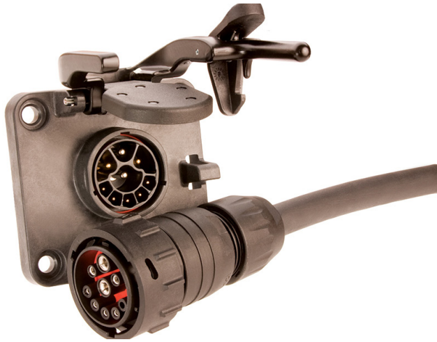
Kuva 76. kylvökoneen ISOBUS-kaapeli ja traktorissa oleva pistoke.
