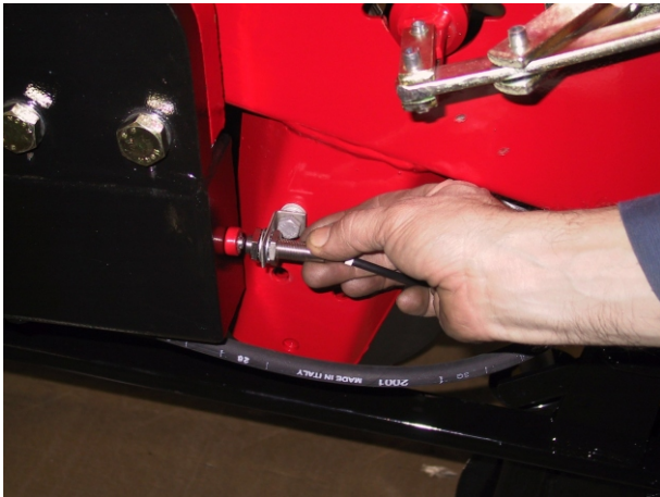
1. Koneen nosto ja laskun anturi sijaitsee kylvölannoittimen oikealla puolella, käsivarren päässä.
