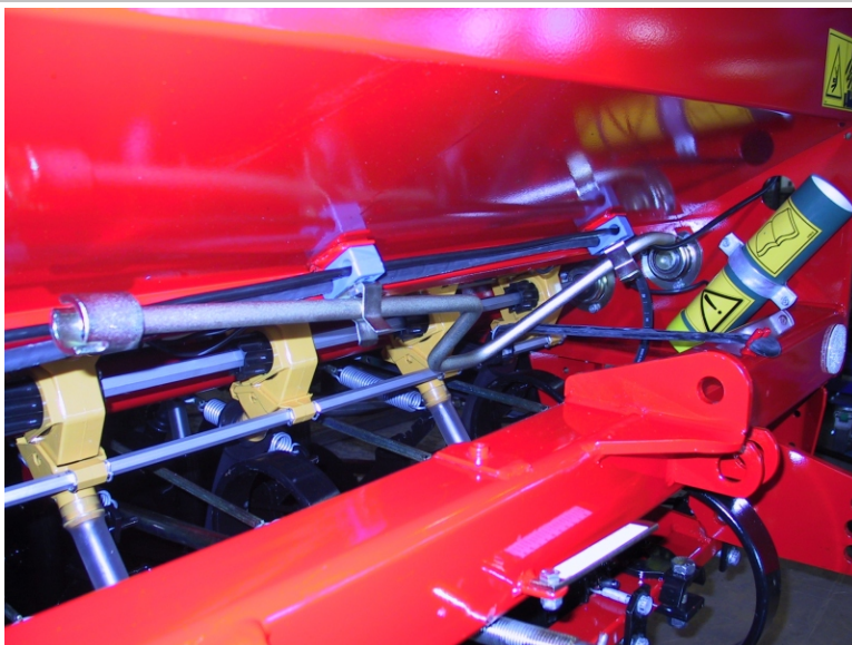
9. Kiertokoeveivin sijoituspaikka (koneen edessä, lannoitesäiliön alla)
