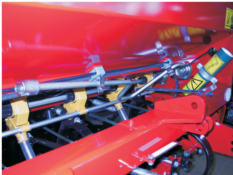
9. Kiertokoeveivin sijoituspaikka (koneen edessä, lannoitesäiliön alla)
