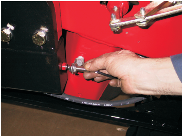
1. Koneen noston ja laskun anturi sijaitsee kylvölannoittimen oikealla puolella, käsivarren päässä.
