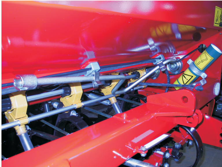
9. Kiertokoeveivin sijoituspaikka (koneen edessä, lannoitesäiliön alla)
