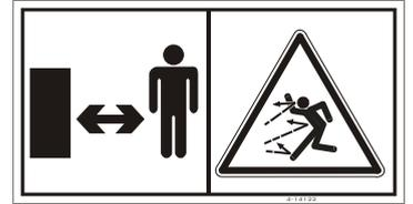
THE AREA OF DANGER IS 20 m FOR SPRAYING DIRECTION
