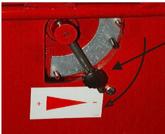
LOCKNUT A AND ADJUSTING LEVER B
