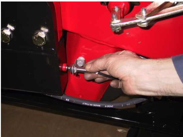
1. Sensoren for løfting og senking av maskinen er plassert på høyre side av maskinen på fremre ende av boggiarmen.
