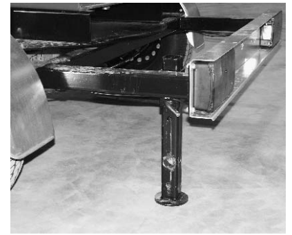
Kuva 7. Tukijalka, alustan takaosassa
