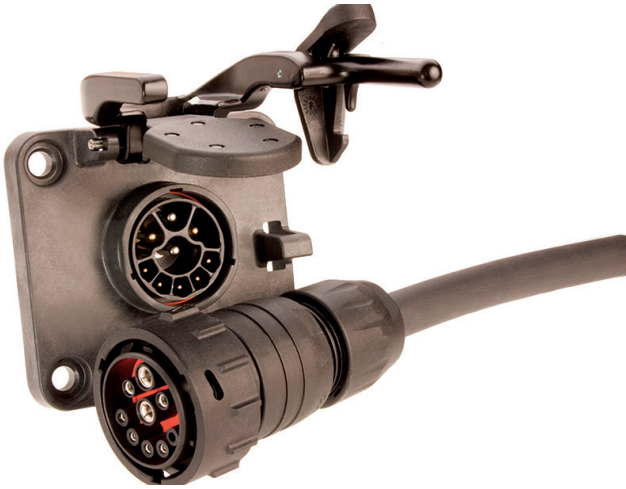
Kuva 1. kylvökoneen ISOBUS-kaapeli ja traktorissa oleva kytkentärasia.
